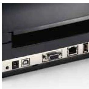
Intégrés par défaut, les ports Ethernet, USB 2.0, série et USB apportent flexibilité et puissance
